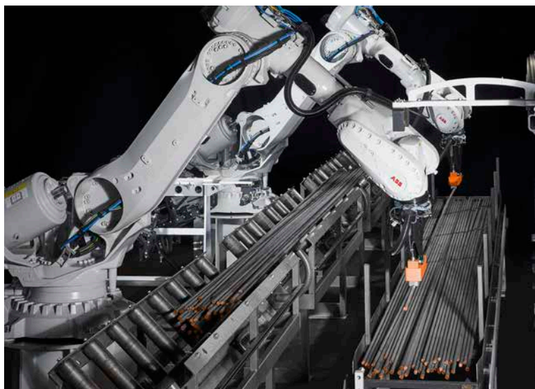
Prélèvement de barres avec un préhenseur magnétique par KASTOpick bar
