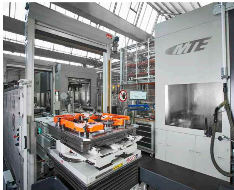
Tour de stockage avec transstockeur pour le stockage intermédiaire des machines de fabrication à CNC
